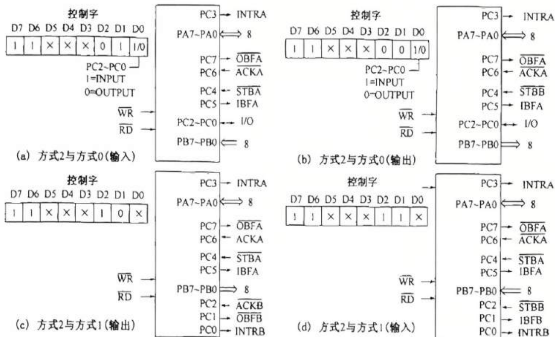
图 7-3-8 方式 2 与方式 0、方式 1 组合引脚定义和控制字
