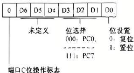
图 7-3-10 端口 C 位操作控制字
