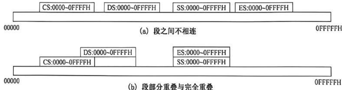
图 2-5-1 程序段及在系统内存中不同的映象
